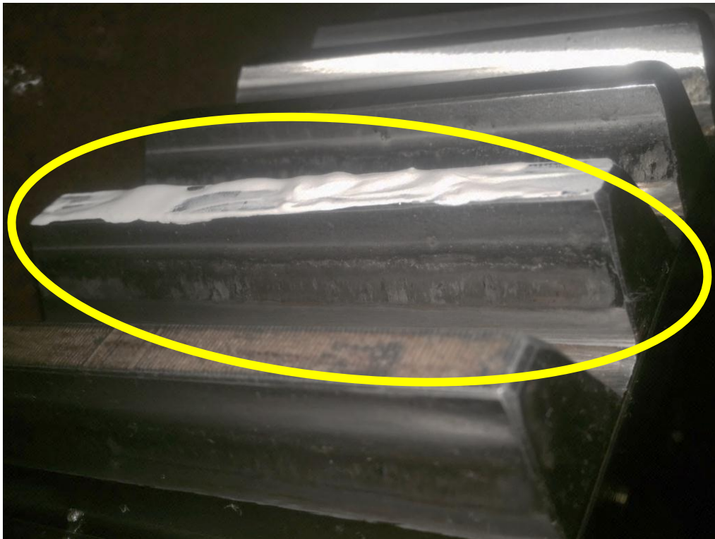
Imagem 3: área da engrenagem onde foi tirada um molde antes do tratamento. Usa-se REWITEC® Replica Set (silicone com 2 componentes)
