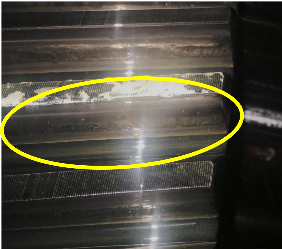
Imagem 5: Área da retirada do molde da superfície depois do tratamento com REWITEC®
